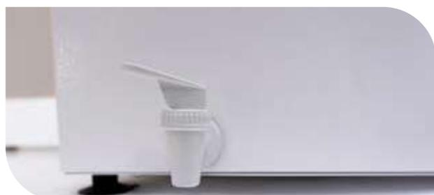
**Dispositivo de drenagem**, que consiste em um tubo ou canal conectado ao recipiente do banho maria, projetado para permitir a drenagem segura do líquido aquecido ou resfriado sem comprometer a integridade da amostra ou do sistema.
