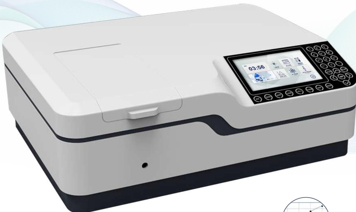
O Espectrofotômetro IL-0082-Y-NM-BI possui um monocromador óptico de duplo feixe. Este equipamento tem uma ótima estabilidade, precisão de leituras e sistema de varredura. Possui alta resolução e calibração automática de 0%T e 100%T. Com recursos de armazenamento, saída para impressora e interface de comunicação com computador a fim de completar as análises e exportar dados para as planilhas.
